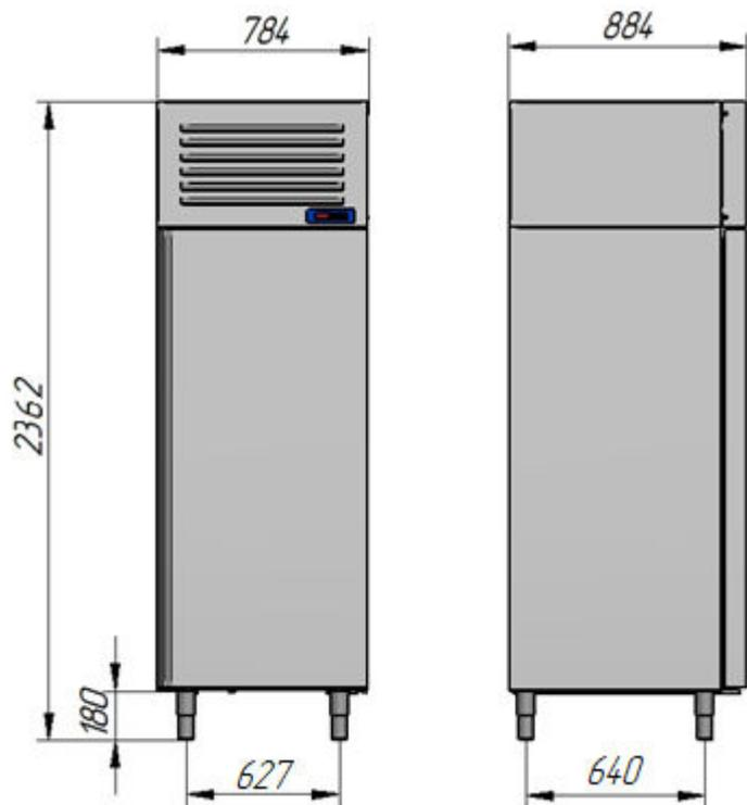
Шкаф шоковой заморозки ШОК-20-1/1М предназначен для быстрого охлаждения и замораживания различных пищевых продуктов на предприятиях общественного питания и торговли для дальнейшего их хранения.
